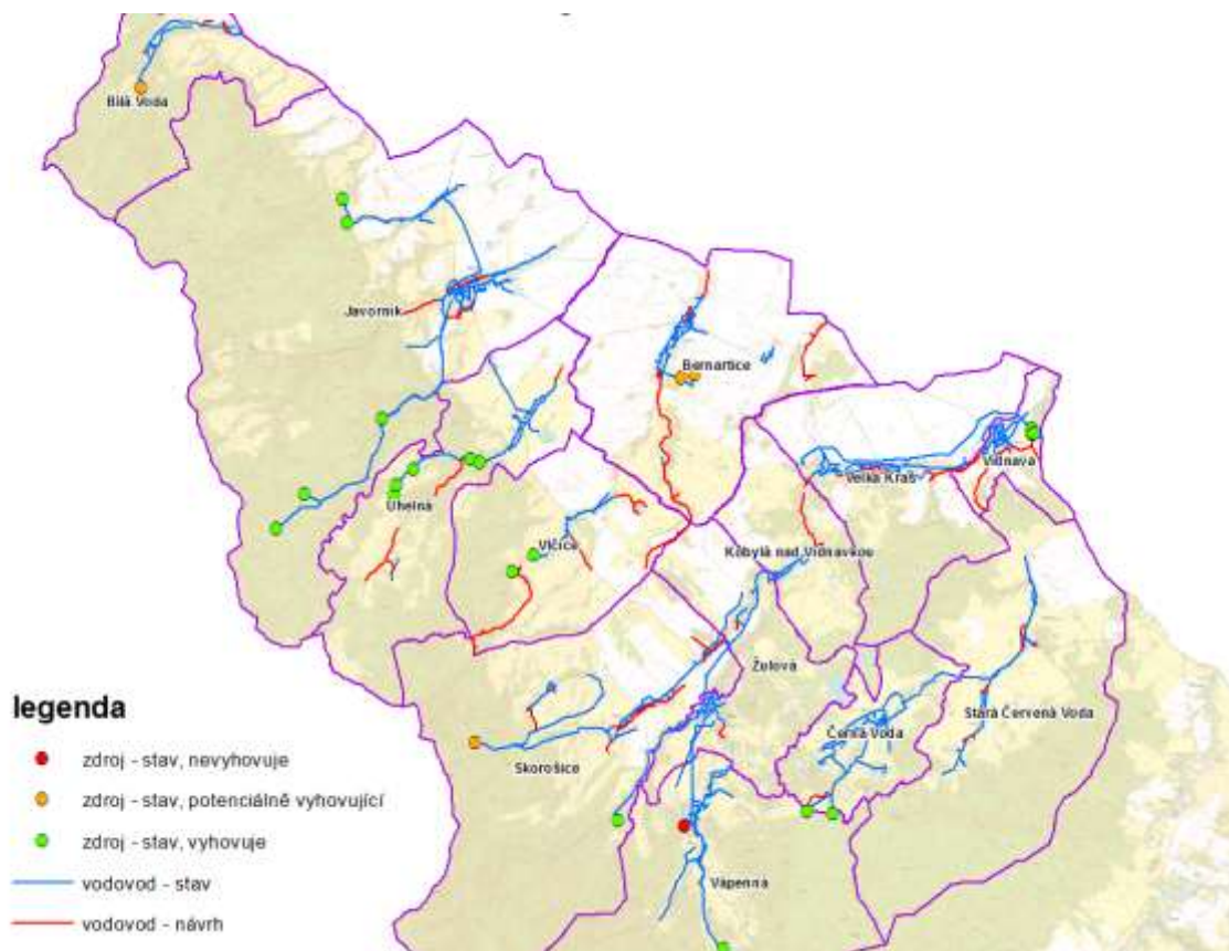
Obr. 5. Posouzení stávajících zdrojů
